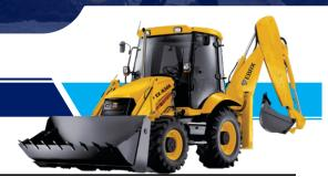
Especificações 14-17,5/19,5L-24 **PNEUS CABINE** Cabine fechada ROPs / FOPs com Ar Condicionado Freio de Serviço Freio a disco com pinça de óleo com tampa de ar **FREIO** Freio de estacionamento freio a ar **CAPACIDADE DO** Tanque de combustível 100 / 130 L **TANQUE**
