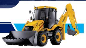
Concha traseira robusta com dentes. Caçamba dianteira com dentes e dois cilindros de basculante.
